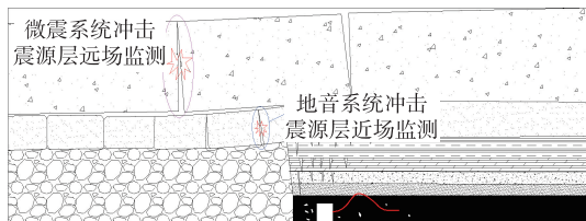
图 10 冲击震源层远近场监测预警技术
