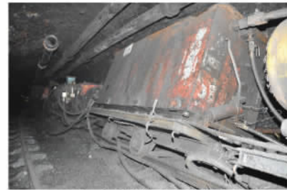
(b) 设备列车被推翻,管道被扯断
