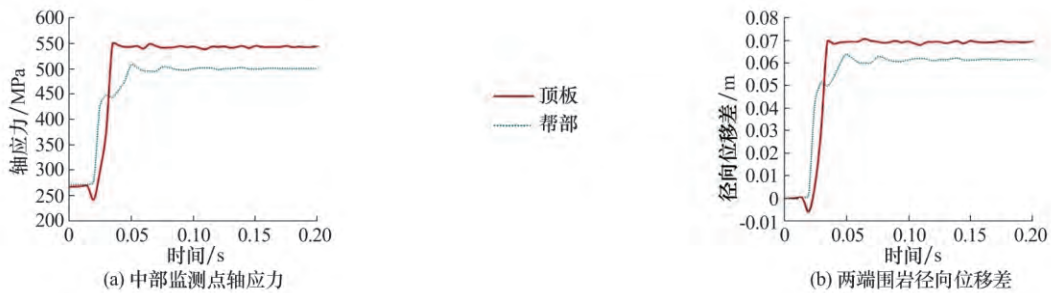
图9 锚杆与围岩特定参数时程曲线
