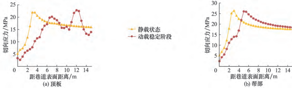
图 7 顶板和帮部围岩切向应力分布
