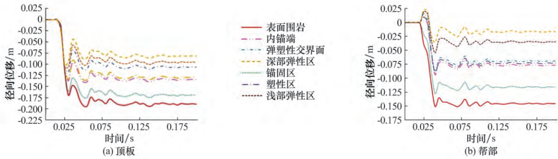
图8 顶板和帮部围岩径向位移时程曲线
