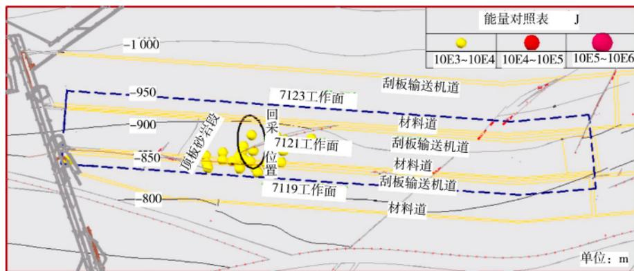
图 24 震源定位平面图(9月21日—30日)
