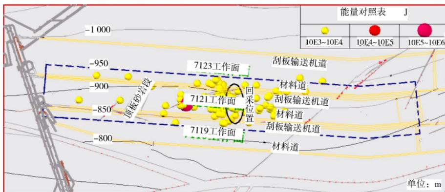
图 18 震源定位平面图(7月21日—31日)
