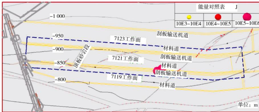
图 28 大能量矿震定位平面图(4月16日、4月18日)
