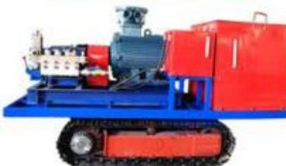
履带式冲孔泵车
