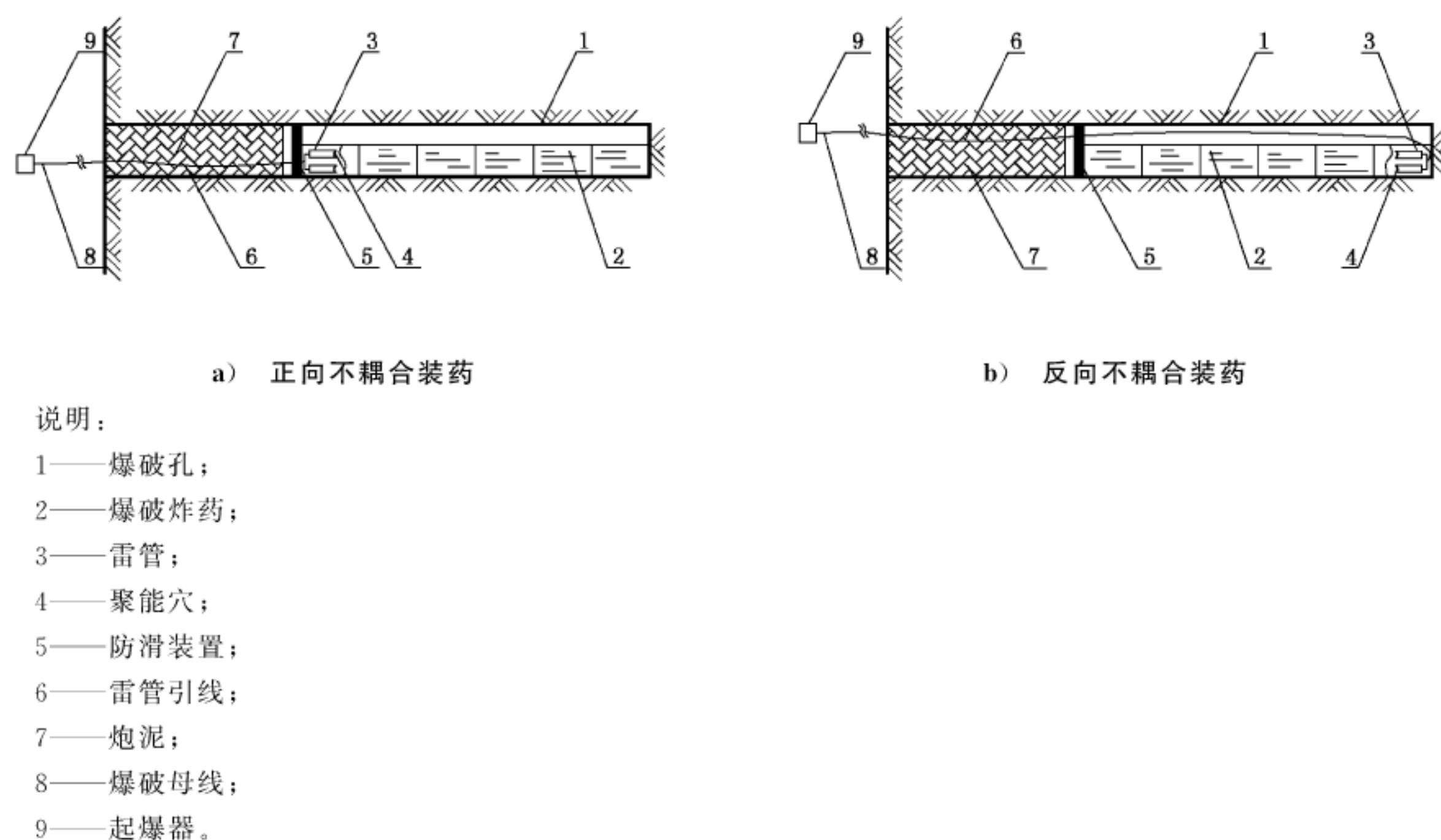
图 4 装药结构示意图
