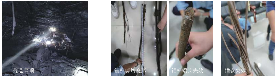
(b) 煤矿现场多次强矿震显现结果
